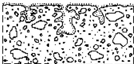
Obrázek 1 — Schematický náčrt typické hydrofobní impregnace
